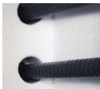
Camera forno con materiale in fibra pregiato e barre di riscaldamento SiC ai due lati
