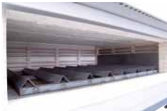
N 1760/S 用于对配有装载支架的板材进行预热
