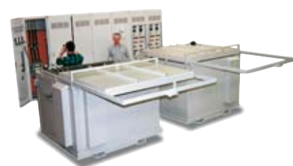
Установка с соляной ванной для отжига алюминиевых деталей в авиационной промышленности
