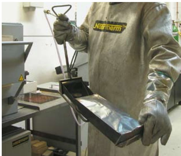
Использование мешков подачи газа
