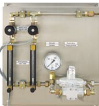
Автоматическая система подачи газа для двух количеств газа для насыщения
