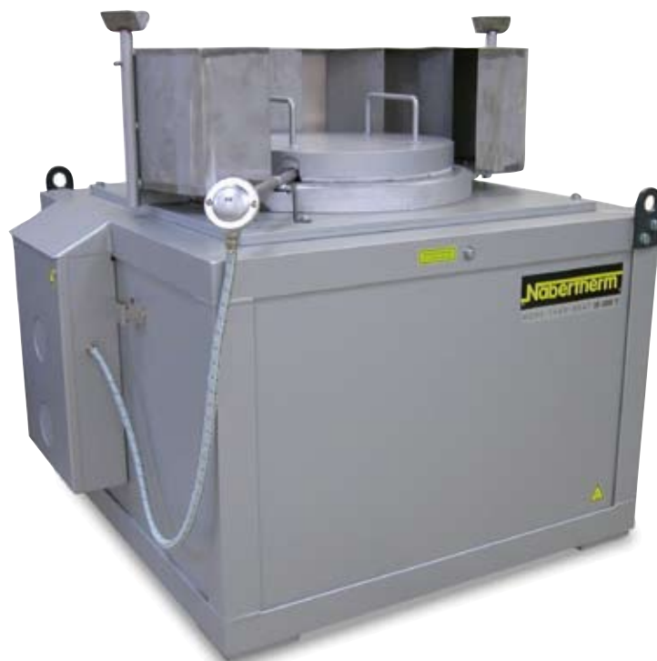
TS 40/30 с системой вытяжки по краям тигеля
