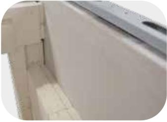
用轻质耐火砖和一个与窑炉的最高温度匹配的节能型后部隔热层组成的多层式隔热结构
