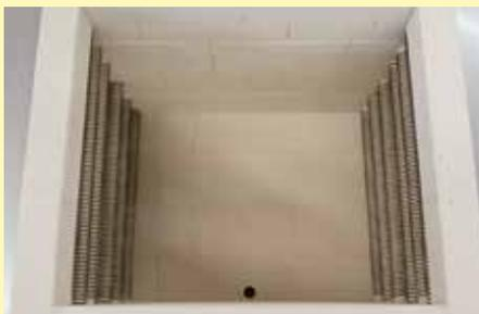
支撑管上的加热元件确保能自由散热
