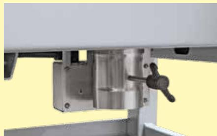
对于300升以下的箱式炉，配置半自动进气阀，用于烘干残余物
