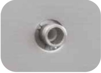
炉门中的目检孔，直径15mm（不适用于N..E型箱式窑）
