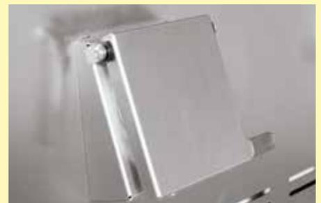
开口可以关闭，用于通风、冷却和观察炉料
