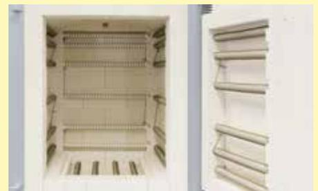
五面加热功能和特殊的加热元件布置确保最佳的温度分布
