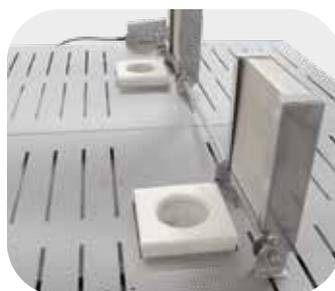
自动排气盖，用于烧制后的快速冷却
