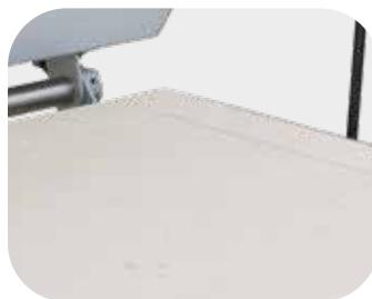
平整的台面用坚固的轻质耐火砖隔热，对放料面作有标记
