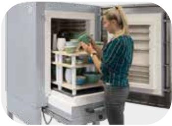
装料高度适宜，带780mm的底座（N 440-N 660型箱式炉=500mm）
