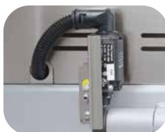
打开炉盖时会关闭加热器
