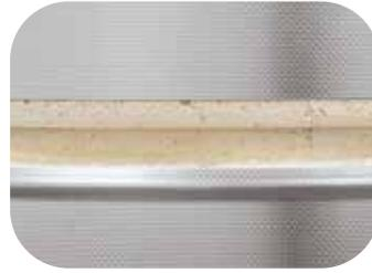
耐用的炉盖密封（隔热砖与隔热砖对接）
