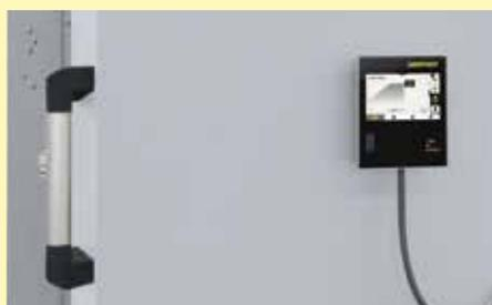
控制器安装在炉门上，为方便操作可以取下
