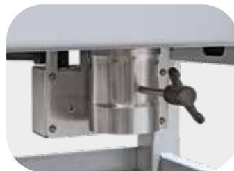
对于300升以下的箱式炉，配置半自动进气阀，用于烘干残余物。达到预设温度时，阀门自动关闭。烘干阶段结束后无需人工关闭进气口
