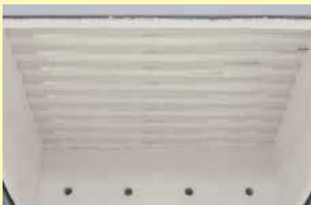
紧密排列的顶部加热元件，外面有石英玻璃保护套管
