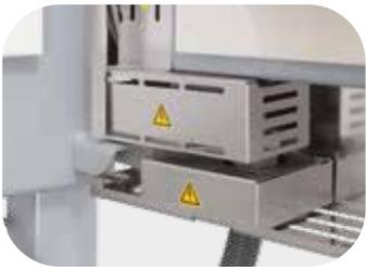
炉门的接触保护开关
