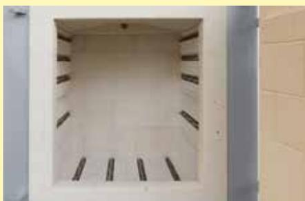
通过嵌入凹槽内受到保护的加热元件进行三面加热
