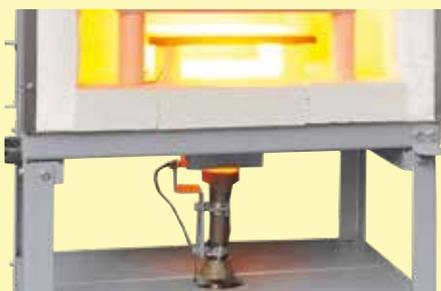
安装在窑炉下方的15kW丙烷燃气燃烧器
