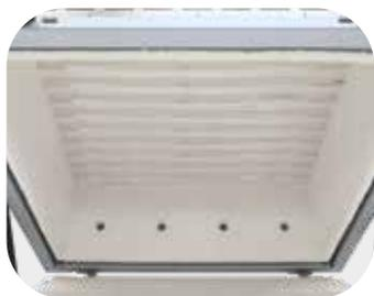
紧密排列的顶部加热元件，外面有石英玻璃保护套管，用于直接和均匀地加热玻璃
