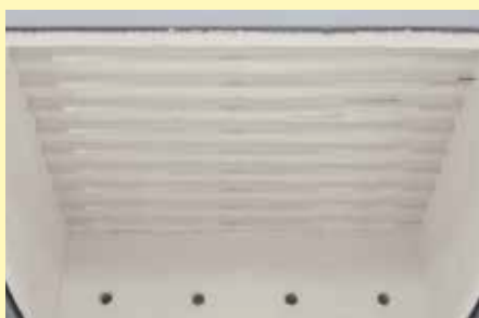
Varmelementer, placeret tæt ved siden af hinanden i toppen og beskyttet i kvartsglasrør
