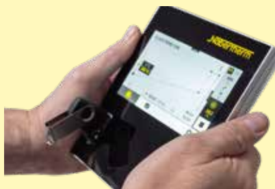
Registrering af procesdata fra den tilsluttede controller via USB-nøgle
