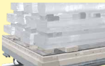
Forno a suola mobile per la malleabilizzazione di barre in quarzo opalino
