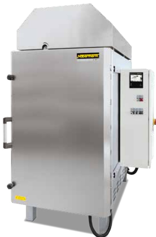
Forno a camera N 660/G con camino per i fumi e impianto di distribuzione laterale (esecuzione speciale)
