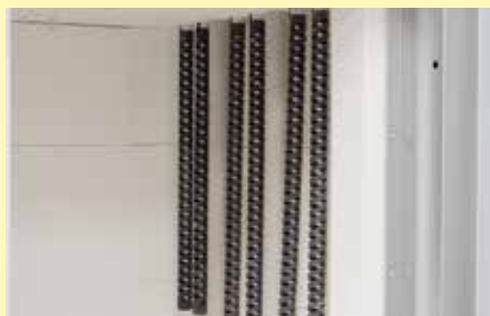
Barre in SiC montate verticalmente e tubi perforati opzionali per ingresso aria del sistema di deceraggio in un forno ad alta temperatura
