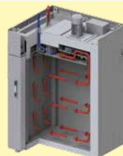
Differenza tra il punto di misurazione e la temperatura media nello spazio utile della camera es. \pm 3 K
