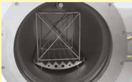
Piano di caricamento e telaio di misura TUS per forno a storte NR 20/11
