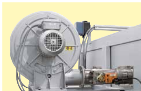
Valvola per accelerare il processo di raffreddamento
