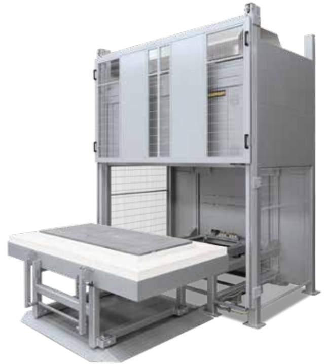
Forno a base sollevabile HF 1220/LBS con isolamento in fibra, recinzione di sicurezza per proteggere la zona di pericolo e tavolo estraibile manualmente per semplificare le operazioni di carico e scarico
