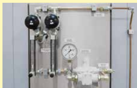
Sistema di gasaggio per gas inerti o di reazione non infiammabili
