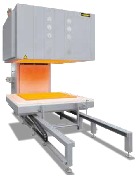
Forni a base sollevabile H 1600/S per il trattamento termico del vetro al quarzo. Il forno è dimensionato per un'apertura a 1000 °C. Tavolo estraibile per la lavorazione dei componenti.
