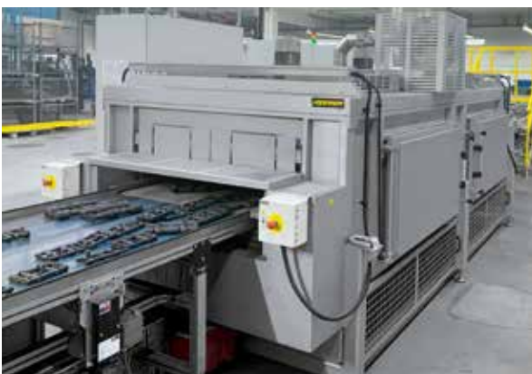
Forno continuo D 1000/4000/140/35 AS per l'essiccazione di rivestimenti su anime in sabbia
