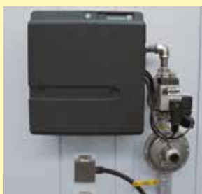
Forni a camera a convezione con riscaldamento a gas, ad es. con bruciatore compatto
