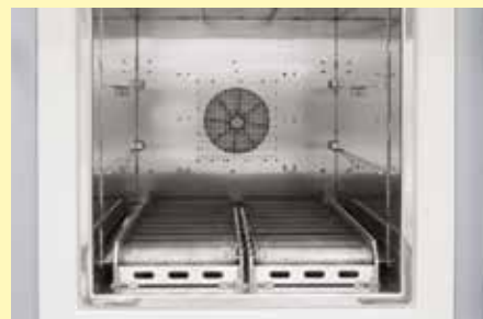
Trasportatore a rulli nel vano forno
