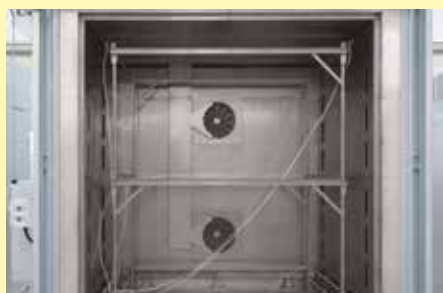
Telaio da assemblare per la misurazione nel forno a circolazione d'aria N 7920/45 HAS
