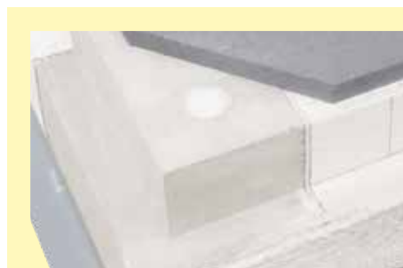
Passaggi per termocoppie (Ø 40 mm) negli angoli anteriori del carrello
