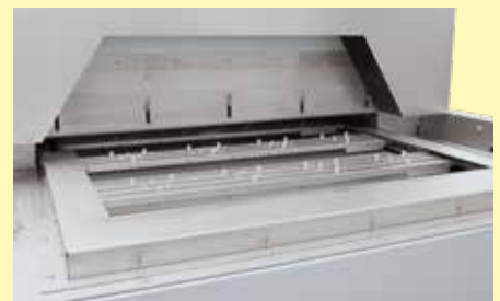
Forno continuo D 1000/1250/200/26AS per la tempera di pezzi stampati a iniezione
