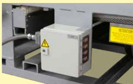
Collegamento termocoppie carica con connessione a innesto
