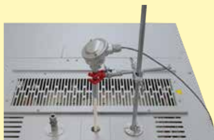
Passaggio per termocoppia nel cielo con cavalletto
