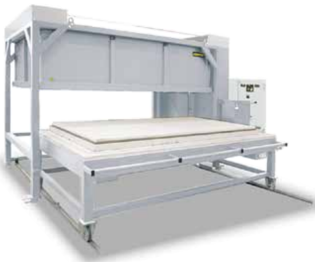
Forno a campana HG 1196/S con riscaldamento nella calotta e nel tavolo; possibilità di spegnere il riscaldamento del tavolo per la vetrofusione.
