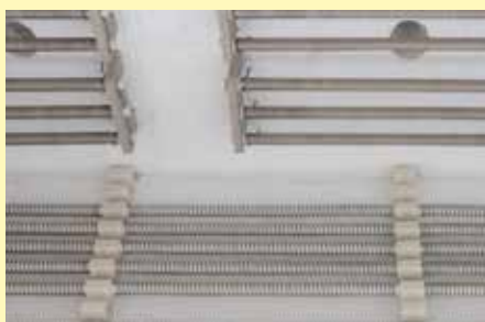
Isolamento in fibra per tempi di riscaldamento e raffreddamento ridotti
