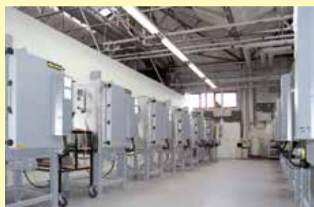
Forni a camera N 200/14 per la sinterizzazione di semiconduttori
