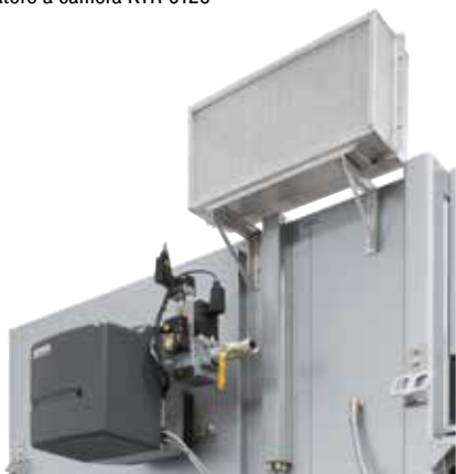
Riscaldamento diretto a gas in un essiccatore a camera
