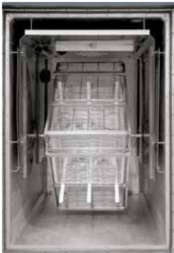
Telaio rotante a motore con cestelli integrati per la movimentazione della carica durante il trattamento termico
