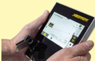
Aufzeichnung von Prozessdaten des angeschlossenen Controllers per USB-Stick
