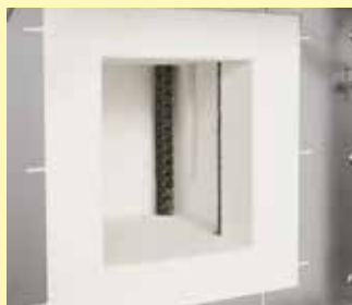
Ofenraum mit hochwertigem Fasermaterial und SiC-Heizstäben in beiden Seiten
