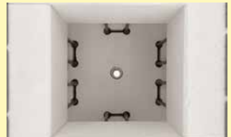
Sehr gute Temperaturgleichmäßigkeit durch Rundumbeheizung des Ofenraums
