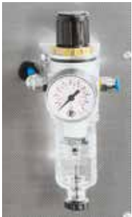
Einstellbarer Pressdruck über Druckluft
