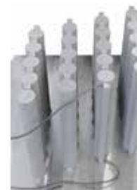
Zugstäbe aus Titan nach der Wärmebehandlung im NR 50/11 unter Argon-atmosphäre
