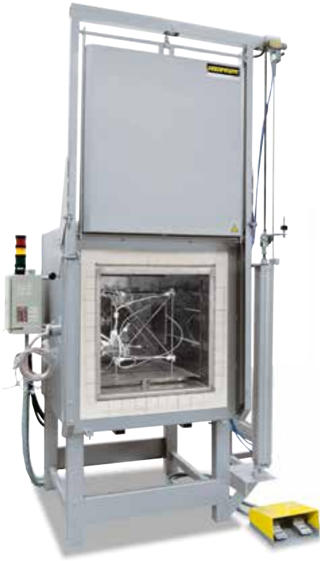
Messgestell zur Ermittlung der Temperaturgleichmäßigkeit
