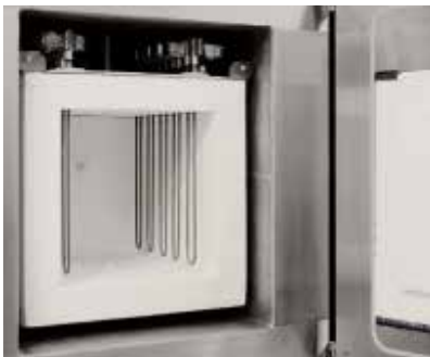
Molybdändisilizid-Heizer mit Faserisolierung
