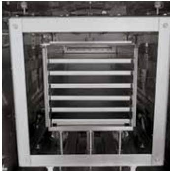
Molybdän-Einsatzkasten mit sechs Chargenauflagen
