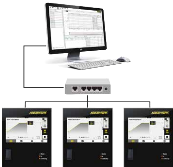
Beispielaufbau mit 3 Öfen
