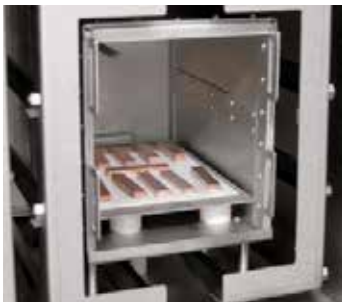
Wärmebehandlung von Kupferstäben unter Wasserstoff im Retortenofen VHT 8/16-MO
