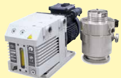
Turbo-Molekularpumpe mit Vorpumpe für Wärmebehandlungen im Vakuum bis 10 -6 mbar
