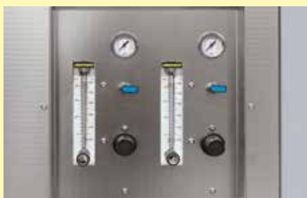
Automatisches Begasungssystem mit Magnetventil und Schwebekörper-Durchflussmesser
