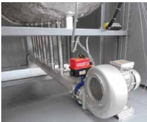
Gebläsekühlung Heißwand-Retortenofen NRA 400/03
