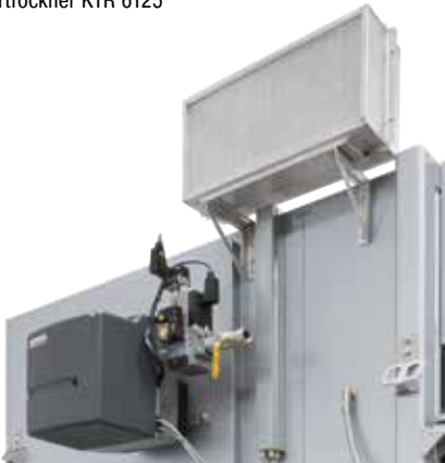
Direkte Gasbeheizung an einem Kammertrockner
