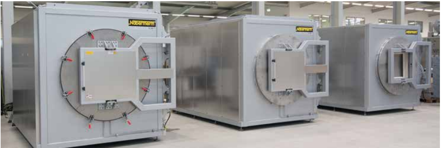
Heißwand-Retortenöfen NR 1000/11 in der Produktion
