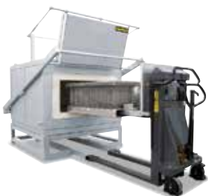
Chargierstapler WS 641 mit Kammerofen N 641 und Einfahrhilfe im Untergestell
