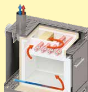
Schematische Darstellung der Luftführung im Veraschungsöfen L 24/11 BO
