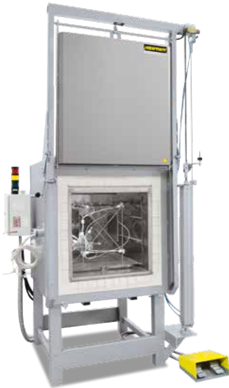
Bâti de mesure pour déterminer l'homogénéité de température
