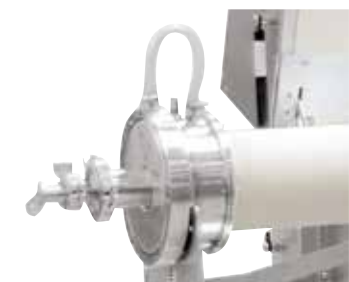
Bride à vide refroidie à l'eau (installation d'alimentation en gaz 2)
