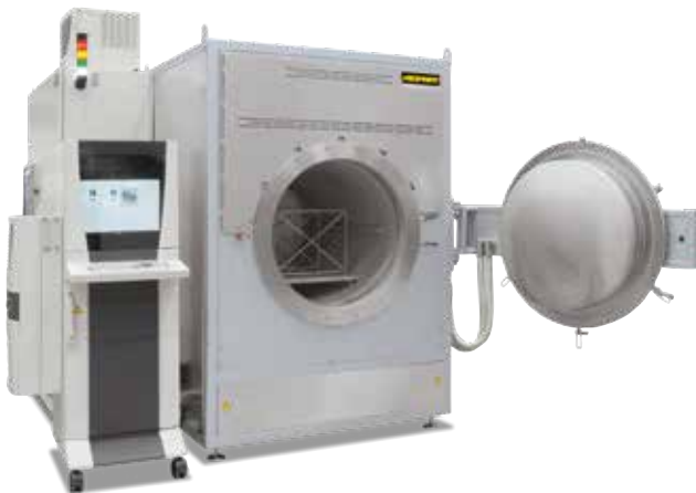
Four moufle étanche NR 300/08 pour le traitement sous vide poussé avec NCC en armoire individuelle
