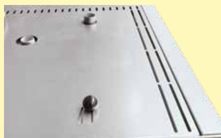
Orifice d'échappement réglable dans le plafond du four
