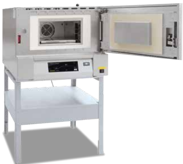
追加装備としてアンダーフレームのある熱風循環式チャンバー炉 NAT 15/85
