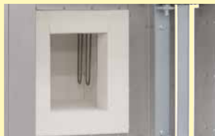
軽量耐火レンガ製断熱と二珪化モリブデン製発熱体
