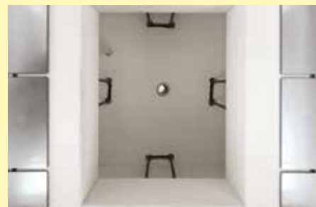
モデル LHT 01/17 LB Speed の 4 面から加熱する炉室
