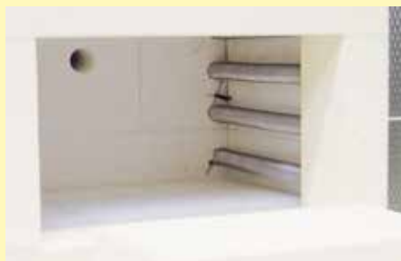
炉内壁の高品質耐火レンガ断熱
