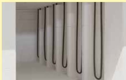
追加装備としての、チャージの出し入れの際に発熱体を機械的破損から守るための安全装置
