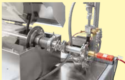
ガス冷却装置とチャージ熱電対のある気密型ロータリー式トランスミッション
