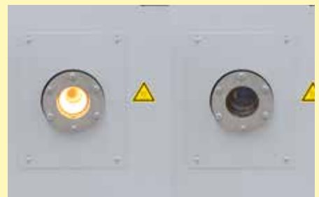
サファイアガラス製冷却点検窓(動作温度の場合は左側、室内温度の場合は右側)
