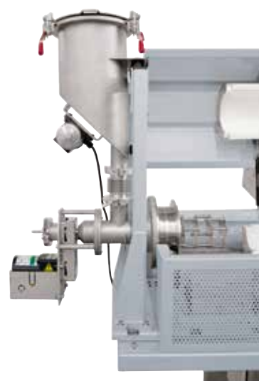
パウダーをより良く供給するため、送入ホッパーに振動ユニットが装備されています
