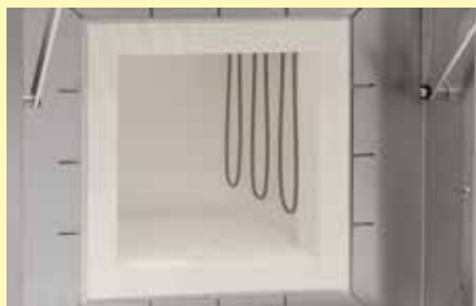
価値の高いファイバー材と二珪化モリブデン製の発熱体が両側面に付いている炉室
