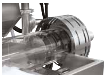
熱放射保護インサートのあるフランジ (ガスパーズパッケージ 15)
