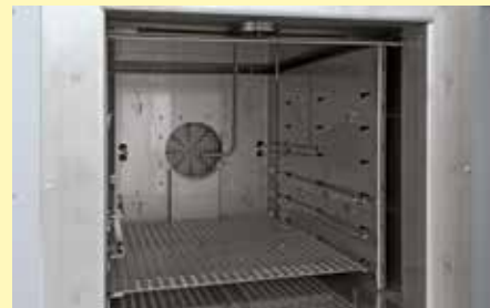
装入プレート、熱電対、圧力監視のある内側空間
