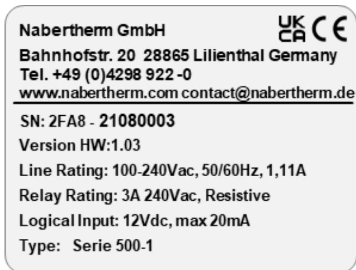
Rys. 7: Przykład (tabliczka znamionowa jednostki sterowniczej)
