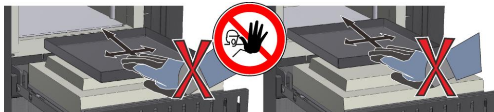
Afb. 36: Voorbeeld: voorkom schade aan de deurisolatie (afbeelding vergelijkbaar)
