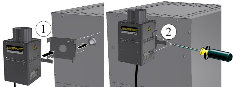
Afb. 22: Afzuigshoorsteen met ventilator (afbeelding vergelijkbaar)
