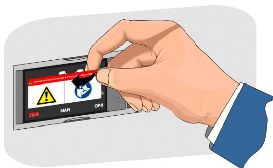
Afb. 13: Sticker verwijderen (afbeelding vergelijkbaar)
