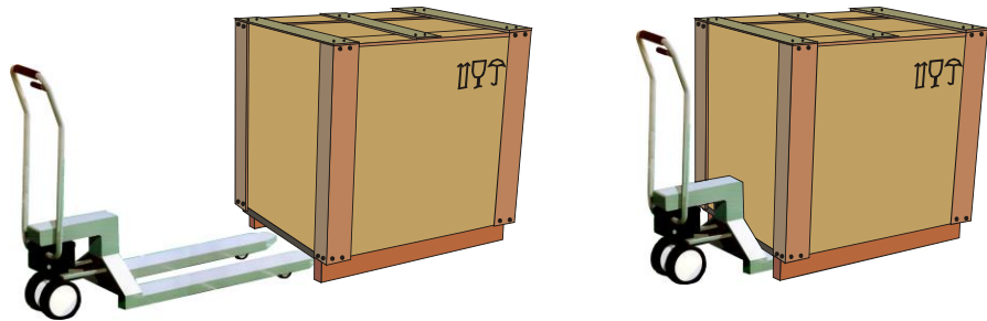
Att. 17: palešu ratiņi pilnībā jāpabīda zem transportēšanas paletes.
