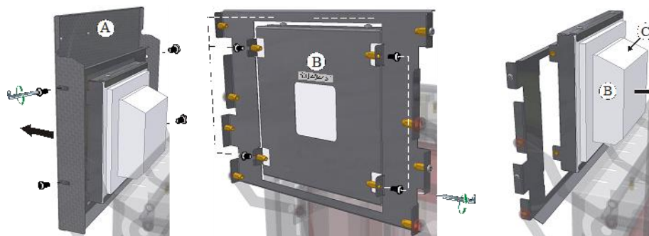
Att. 48: durvju apšuvuma/durvju izolācijas demontāža (skatīt attēlu)
