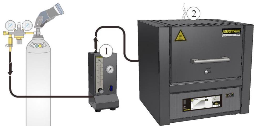
Fig. 50: Conexión al sistema de gasificación (figura análoga)
