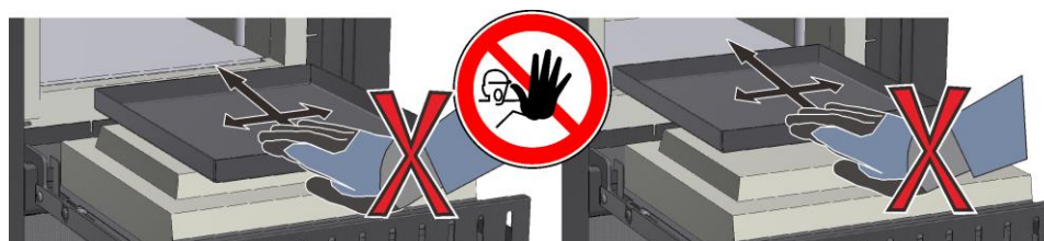
Fig. 36: Ejemplo: Prevención de daños en el aislamiento de la puerta (figura análoga)
