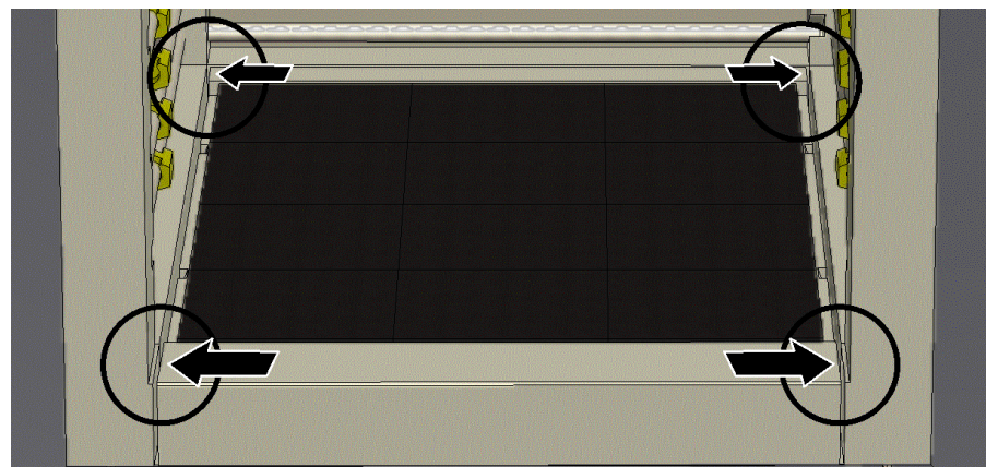
插图43：在整个长度范围内检查高度（和插图类似）
