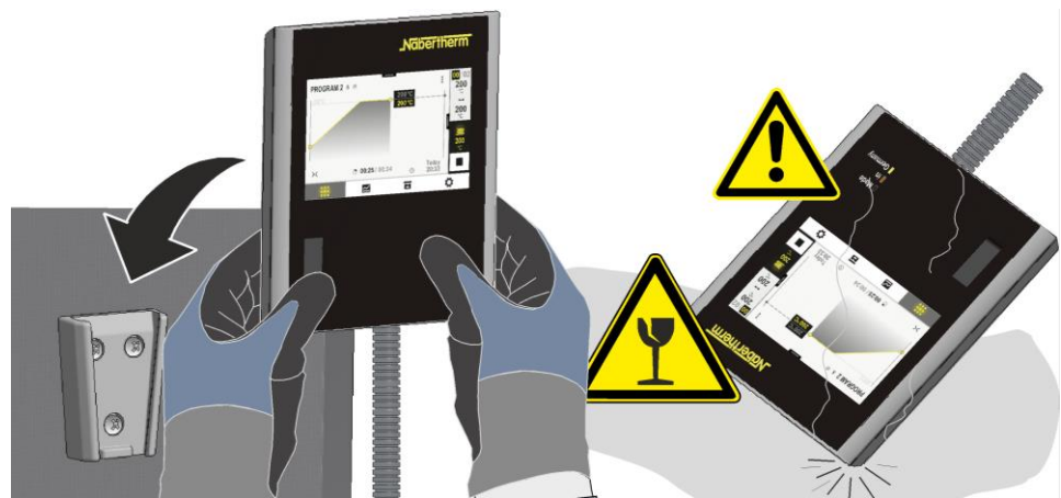
插图 55：将控制器插入位于电炉上的支架中（与插图相似）
