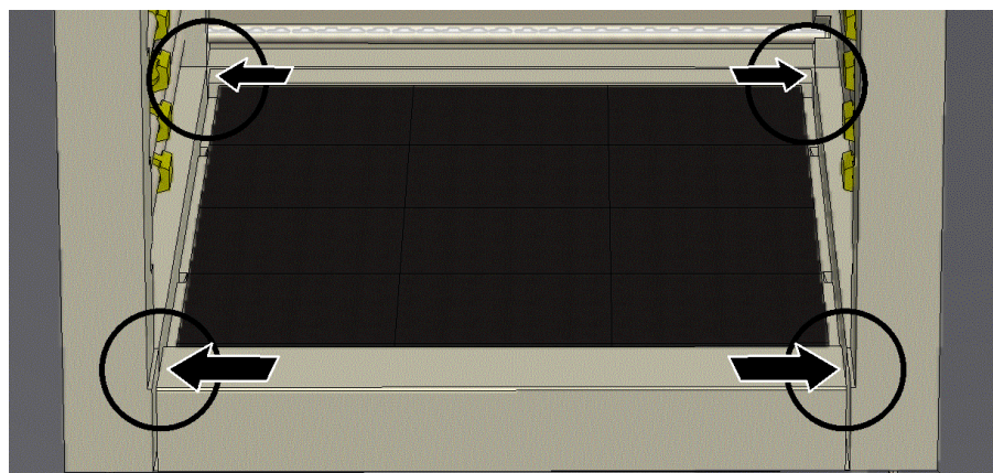
插图36: 在整个长度范围内检查高度 (和插图类似)
