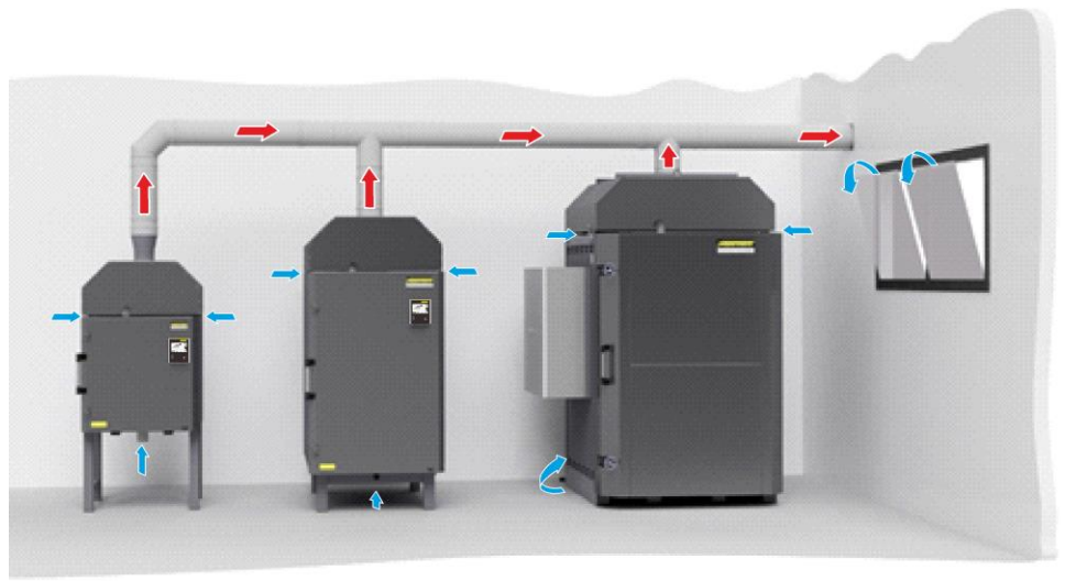
图示58：活动状态下的抽吸设备示例（图示根据型号）
