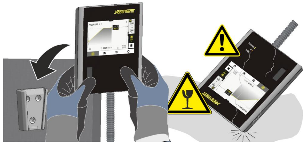
插图 71：将控制器插入位于电炉上的支架中（与插图相似）
