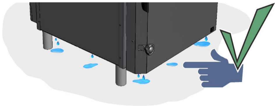
图示67：最初几次燃烧时出现的冷凝水积聚（和图示类似）
