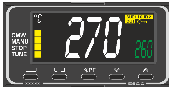
插图 72：温度选择限幅器(与插图相似)
