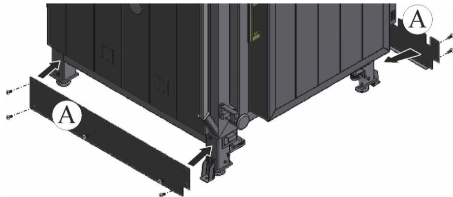
插图46：装配侧面金属板(与插图相似)
