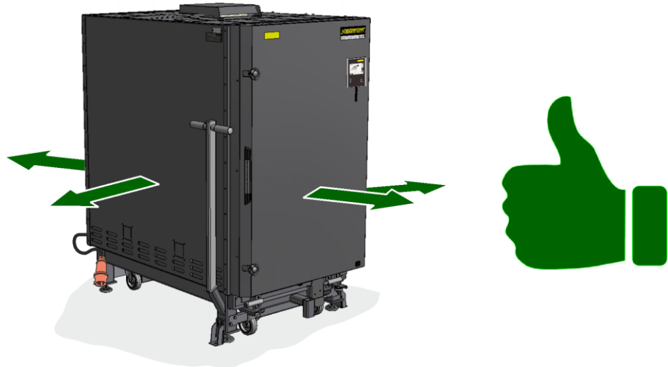
Afb. 38: Oven neerzetten en positioneren (afbeelding vergelijkbaar)
