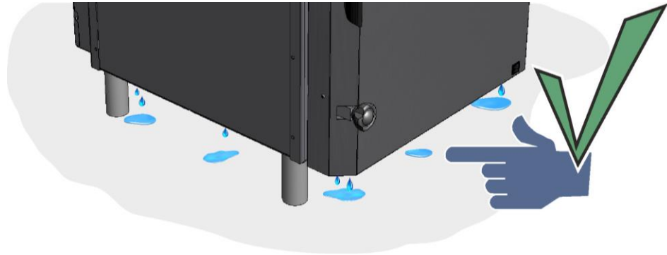
Afb. 67: Condensaatophoping tijdens de eerste branden (afbeelding vergelijkbaar)
