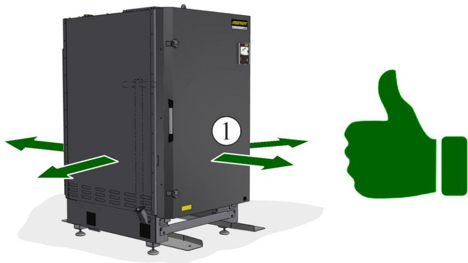
Afb. 28: Oven neerzetten en positioneren (afbeelding vergelijkbaar)
