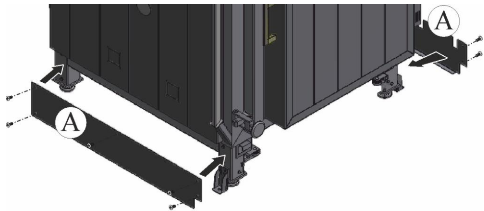
Afb. 46: montage van de zijplaten (afbeelding vergelijkbaar)
