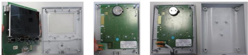
Abb. 15: Einbau der Controllerplatine – Teil 2 (Abbildung ähnlich)
