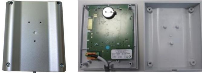
Abb. 11: Austausch eines Controllers (Abbildung ähnlich)
