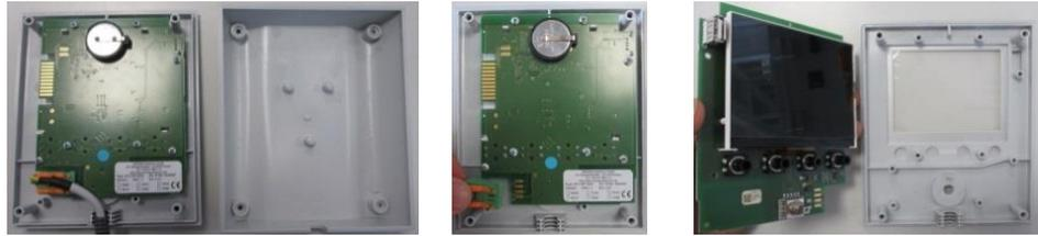
Abb. 13: Ausbau der Controllerplatine – Teil 2 (Abbildung ähnlich)
