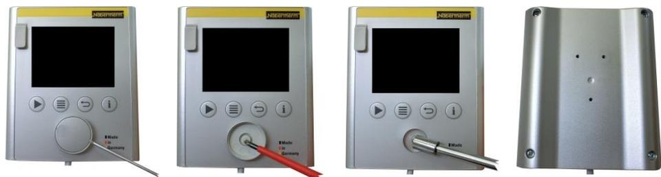
Abb. 12: Ausbau der Controllerplatine – Teil 1 (Abbildung ähnlich)
