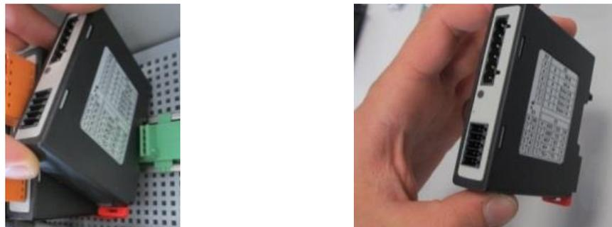
Abb. 18: Ausbau der Reglermodule – Teil 2 (Abbildung ähnlich)
