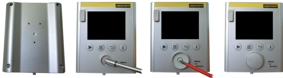
図16:コントローラ基盤の取り付け - 第三弾 (図に類似)
