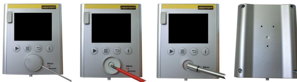
図 12: コントローラー基盤の解体 - 第一弾（図に類似）
