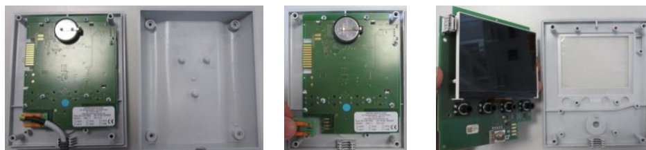
図 13: コントローラー基盤の解体 - 第二弾（図に類似）
