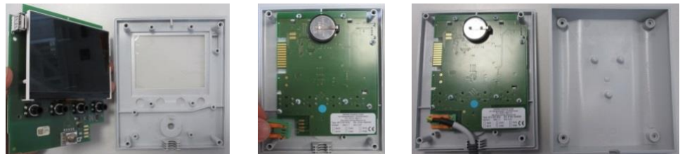
図 15: コントローラー基盤の取り付け- 第二弾 (図に類似)
