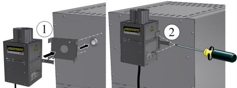
**(C) Abzugskamin mit Ventilator und Katalysator**
