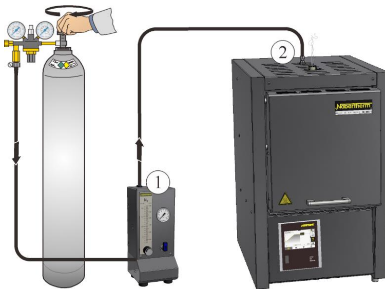
58. ábra: Csatlakoztatás a gázosító rendszerhez (az ábrán láthatóhoz hasonlóan)
