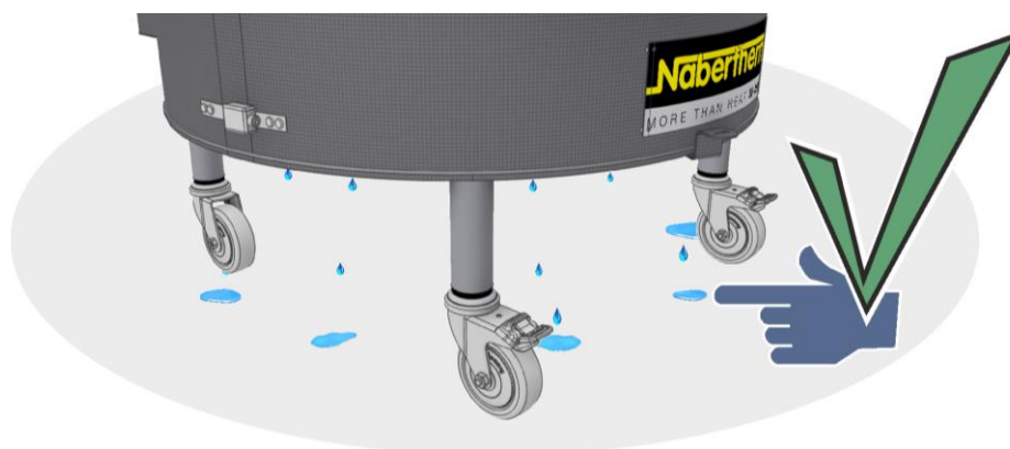
Obr. 29: Hromadění kondenzátu během prvních výpalů (přibližný obrázek)
