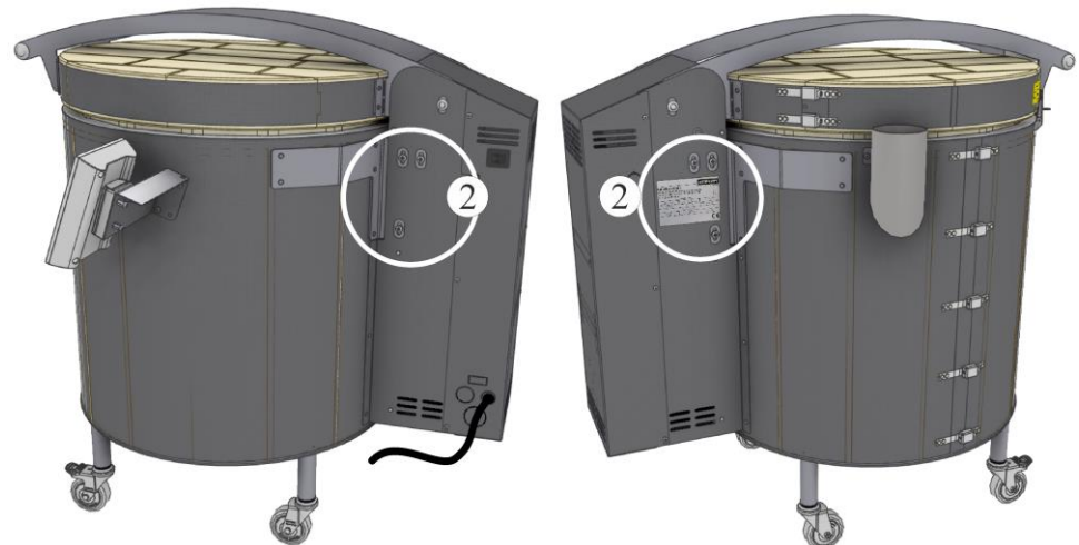
Viti presenti su entrambi i lati della copertura dell'impianto di distribuzione per la regolazione del coperchio
