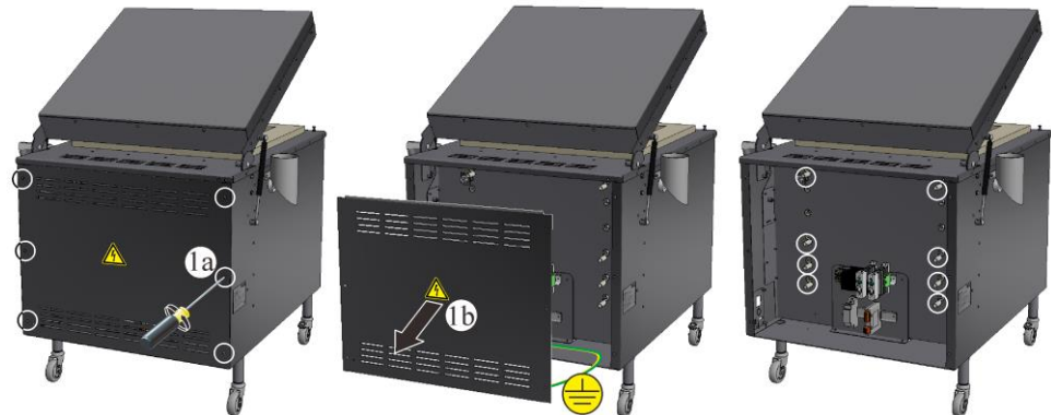
Fig. 75: Smontare la copertura dell'impianto di distribuzione dal lato posteriore del forno (illustrazione simile)
