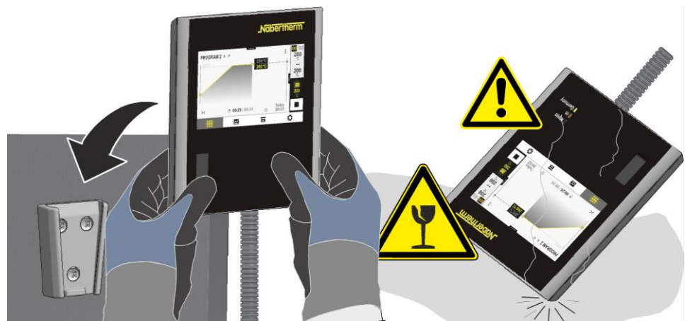
Fig. 33: Inserire il controller nel supporto presente sul forno (illustrazione simile)
