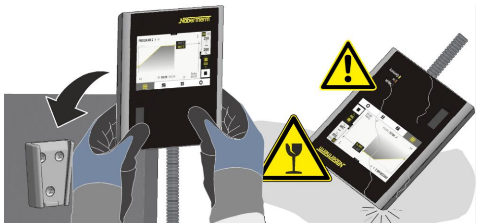
Fig. 21: Inserire il controller nel supporto presente sul forno (illustrazione simile)
