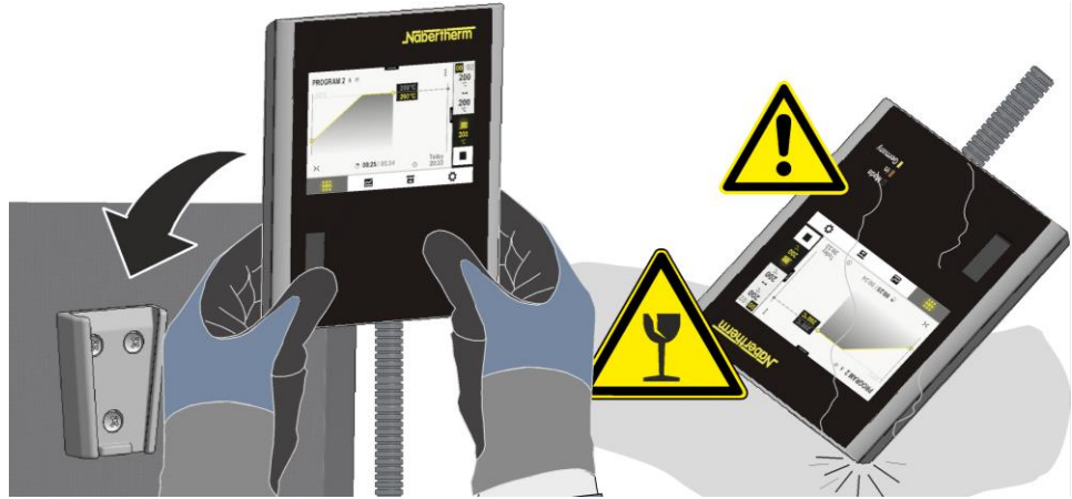
Fig. 21: Sette styringen inn i holderen på ovnen (illustrasjonen kan avvike)
