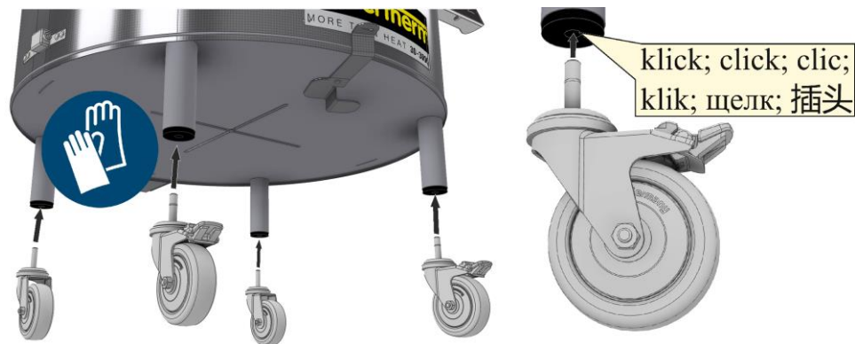
Fig. 15: Montering av transporthjulene (illustrasjonen kan avvike)
