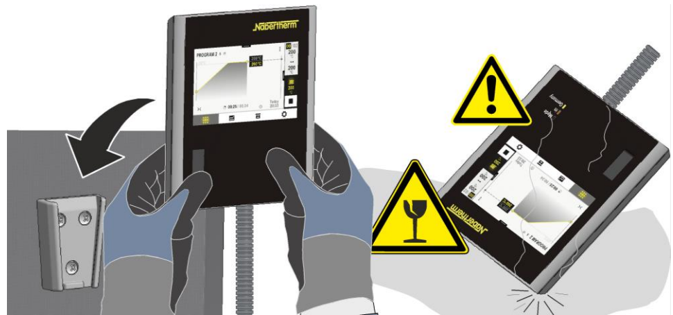
Fig. 33: Sette styringen inn i holderen på ovnen (illustrasjonen kan avvike)
