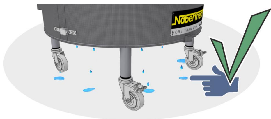
Fig. 29: Kondensansamlinger under de første brenningene (illustrasjonen kan avvike)
