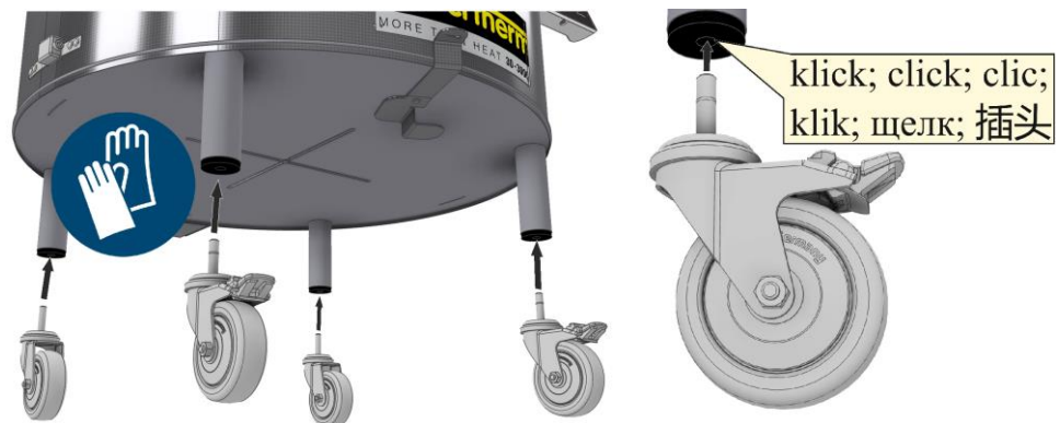
Obr. 15: Montáž dopravných koliesok (podobne ako na obrázku)
