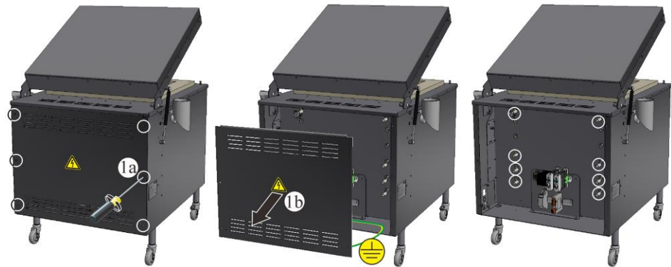
Obr. 75: Demontáž krytu spínacieho zariadenia zo zadnej strany pece (podobne ako na obrázku)
