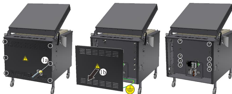
Fig. 76: Demontera kopplingsanläggningens skyddsbeklädnad på ugnens baksida (bilden är en liknande bild)
