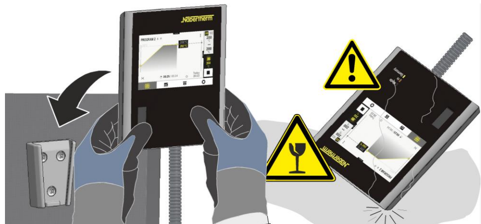
Bild 22: Isättning av kontrollern i den hållare som finns på ugnen (liknar den på bilden)
