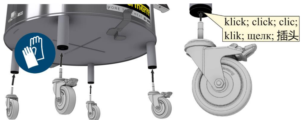
Fig15: Montera transportrullarna (bilden är en liknande bild)
