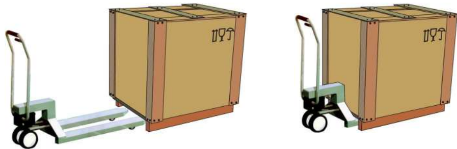
ภาพ 14: รถลากพาเลทถูกผลักไปใต้โครงสำหรับขนส่ง จนสุด
