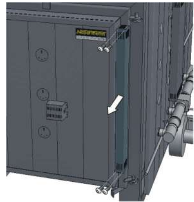
ตัวอย่าง: ฝาครอบสำหรับเชื่อมต่อตัวทำความร้อนที่ประตู
