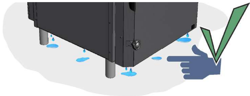
ภาพ 67: การสะสมของของเหลวผลควบแน่นในระหว่างการเผาครั้งแรก (เหมือนกับภาพ)
