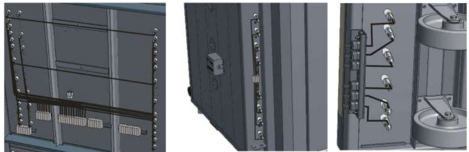
ตัวอย่าง: ขั้วปลายตัวทำความร้อนที่ผนังด้าน หลัง (พื้น)
