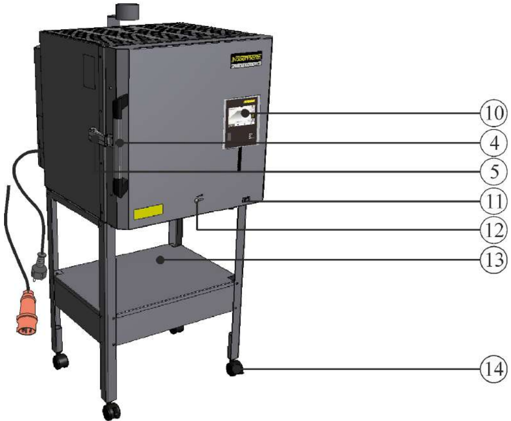
ภาพ 1 : ตัวอย่าง: เตาแบบห้อง รุ่น N 40 E (รุ่นตั้งโต๊ะ) พร้อมอุปกรณ์เสริม โครงฐานและลูกกลิ้งลำเลียง
